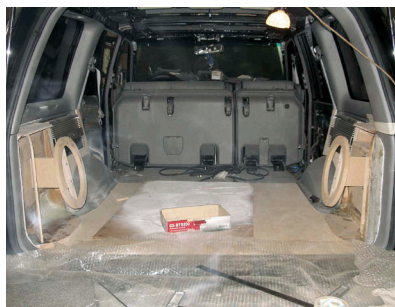
Примерка каркасов перед выклейкой композитной части
