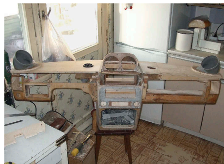
Поворотные подиумы среднечастотных динамиков. Даже в крайних положениях не удалось добиться желаемой ширины сцены, в итоге этот вариант торпеды отправился на помойку...
