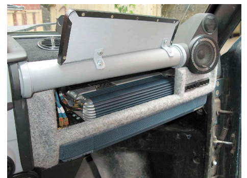
Внутри перчаточного ящика — LRx 2.250, шестиканальный LRx 6.9 — снизу
