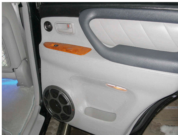
Задние двери со временем оказались переделаны под такие же, 9-дюймовые, динамики
