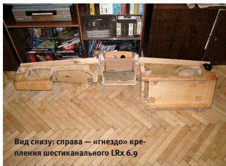
Приборы перенесены в центр торпеды
