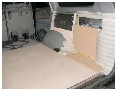
Одновременно строится плоская часть задней стенки сабвуфера
