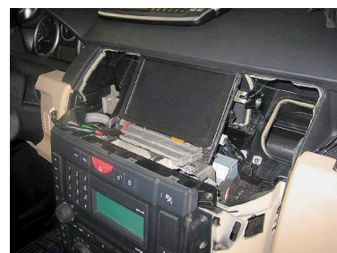
Дисплей планировалось установить на место кармана на верху торпедо. Только для этого его пришлось урезать и расчленив
