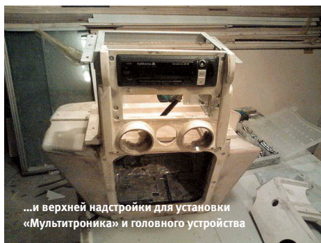
Верхняя часть надстройки из алюминиевых профилей
