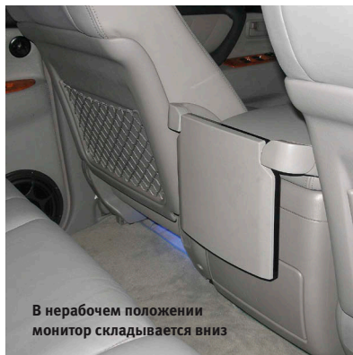
Монитор для задних пассажиров при рождении был потолочным. Главным было обеспечить надёжность фиксации монитора и... переворот матрицы вверх ногами
