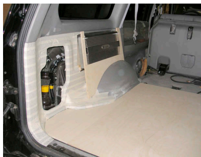
Установка компонентов в багажнике начата с усилителей
