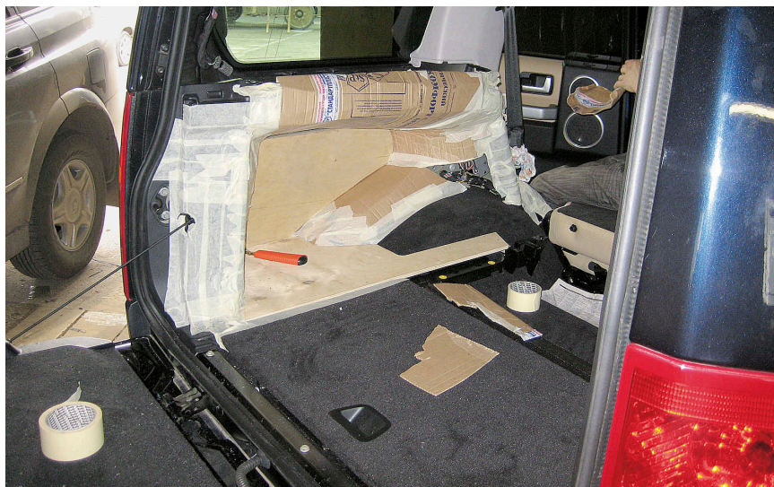
Корпус сабвуфера — комбинированный, всё плоское — из фанеры, усиленный стеклопластиком, неплюсское — из одного стеклопластика
