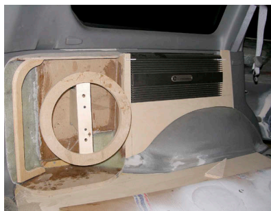
Каркас остальных стенок и фронтальное кольцо на технологической опоре
