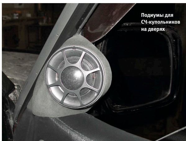
При закрытой двери СЧ и ВЧ-излучатели максимально сближены
