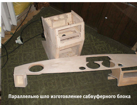
Приборы перенесены в центр торпеды
