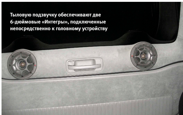
На базе обивки пятой двери были построены подиумы для тыловой акустики
