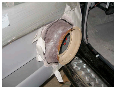
Карты дверей, обезображенные прошлой установкой, стали основой для мощных подиумов с креплением на металл
