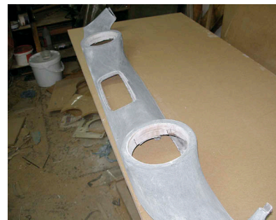
На базе обивки пятой двери были построены подиумы для тыловой акустики
