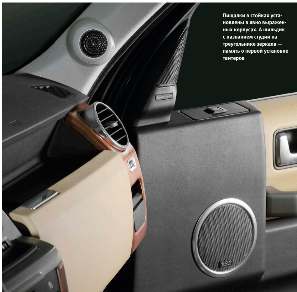
Двери внешне остались нетронутыми, но пищалки позже перенесли
