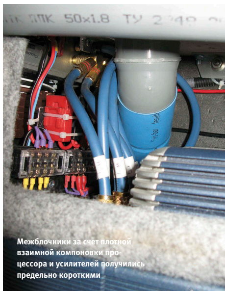
Внутри перчаточного ящика — LRx 2.250, шестиканальный LRx 6.9 — снизу
